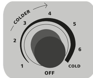
Wenn die Umgebungstemperatur hingegen sehr niedrig ist oder die Kühlbox leer oder nur leicht beladen ist, kann die Innentemperatur unter 0 °C fallen. Dies könnte dazu führen, dass der Verdampfer einfriert. Um dies zu vermeiden, stellen Sie den Thermostat etwas nach links.
